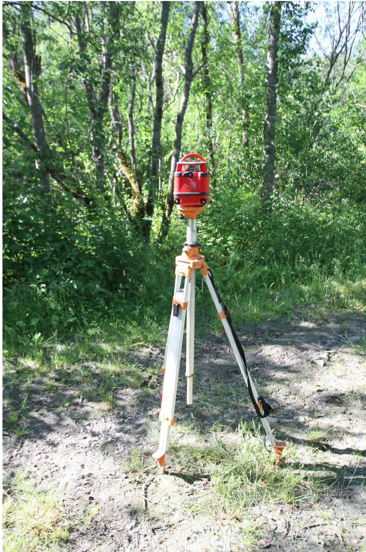
Figur 2: Laser til måling av nivåforskjell.
