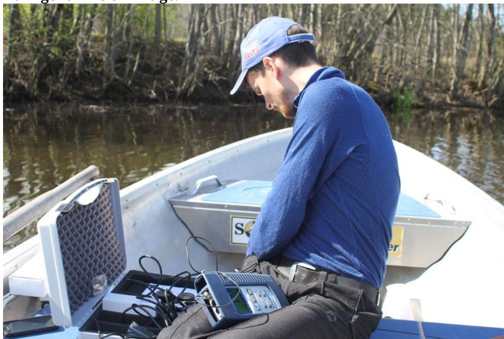
Figur 1: Måling av øyeblikksbildet på pH, oksygenmetning og temperatur.
