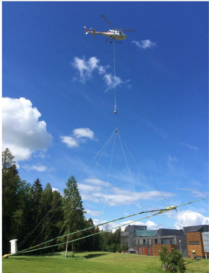
Figur 3, Takeoff med SkyTEM-ustyret og helikopter fra AirLift (Campus Vestfol)
