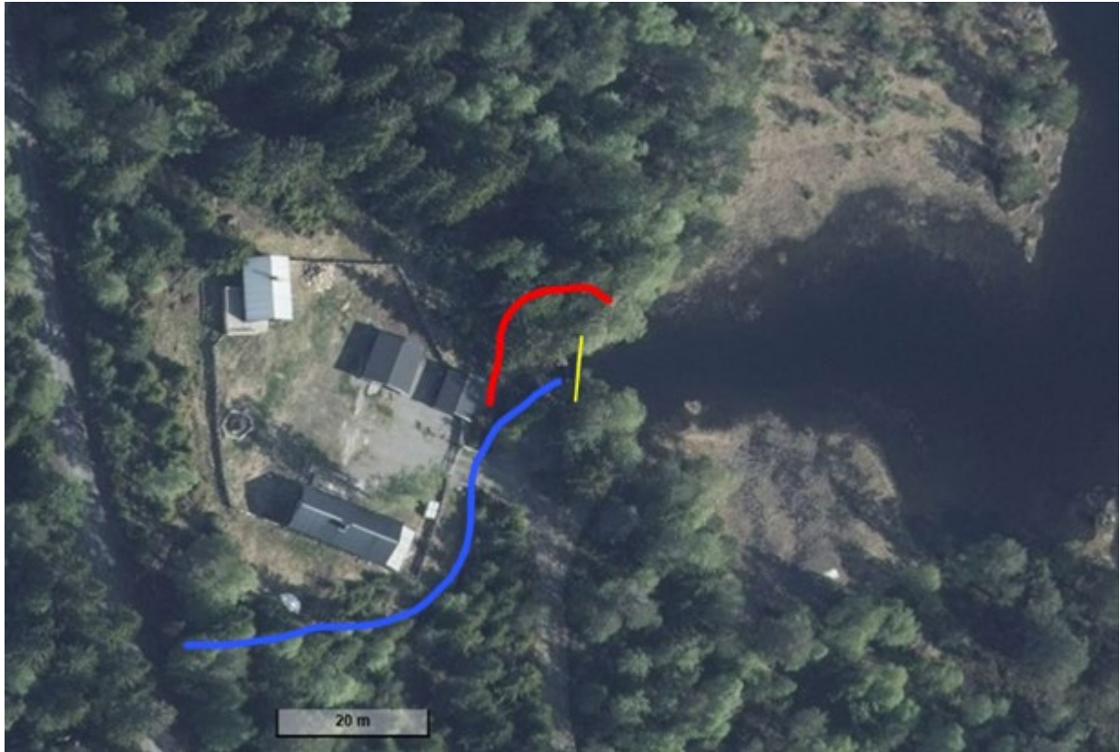
Figur 31. Oversiktsskisse av omløp (rød linje) på nordsiden av demningen (gul linje) ved Djupøyungen. Blå linje markerer dagens bekkeløp. Kartgrunnlag: Kartverket.
