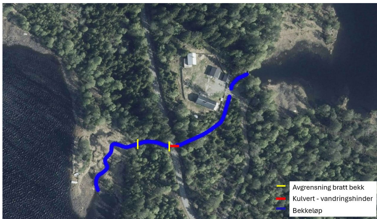
Figur 16. Djupøyungsbekken med bekkeløp tydeliggjort i blått, fra Djupøyungen til høyre – ned til Storøyungen til venstre. Kulvert ved innkjørsel til hyttetunet øverst i bekken er ikke et vandringshinder. Veikulvert (oppstrøms vandringshinder) vises i rødt. Gule linjer markerer bratt bekkeløp som fungerer som vandringshinder for fisk. Kilde: Kartverket.
